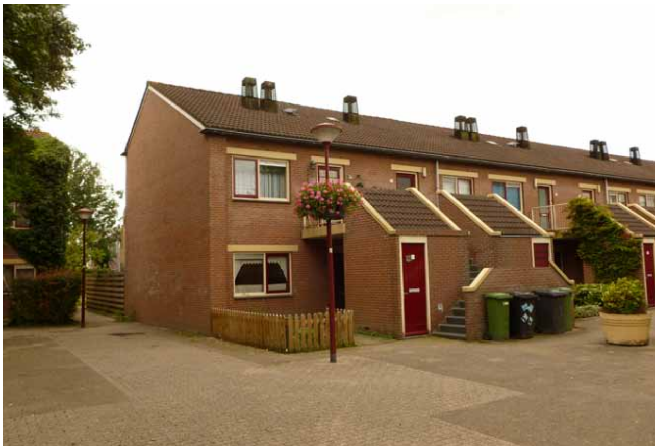
Type 1 staat aan de Landauerdrift. Deze woningen kennen een afwijkende materialisering (metwielwerk gevels en bergingen). Het dak van de bergingen is in slechte staat, dit geeft de mogelijkheid om deze woningen een groenere uitstraling aan de Landauerdrift te geven
