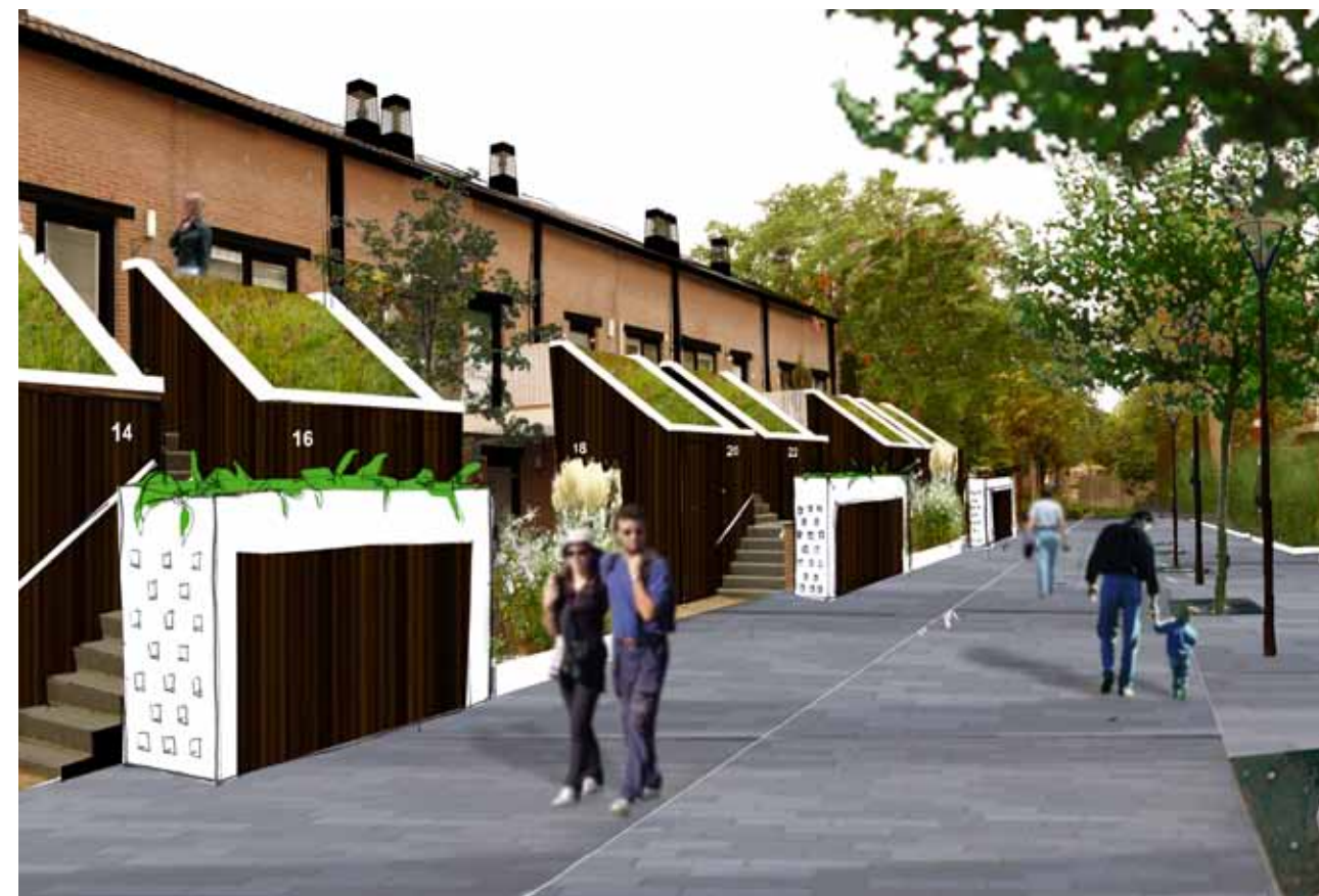
Naast de belangrijke make-over van de Landauerdrift krijgen de bergingen een groendak en nieuwe bekleding die aansluit bij de rest van de wijk. Door een nieuwe dakrand en hwa's transformeert dit uniforme rijtje woningen daarnaast ook in afleesbare units.
